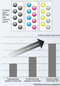
Струйные печатающие головки ComColor GD: 300 dpi x 2 линии
